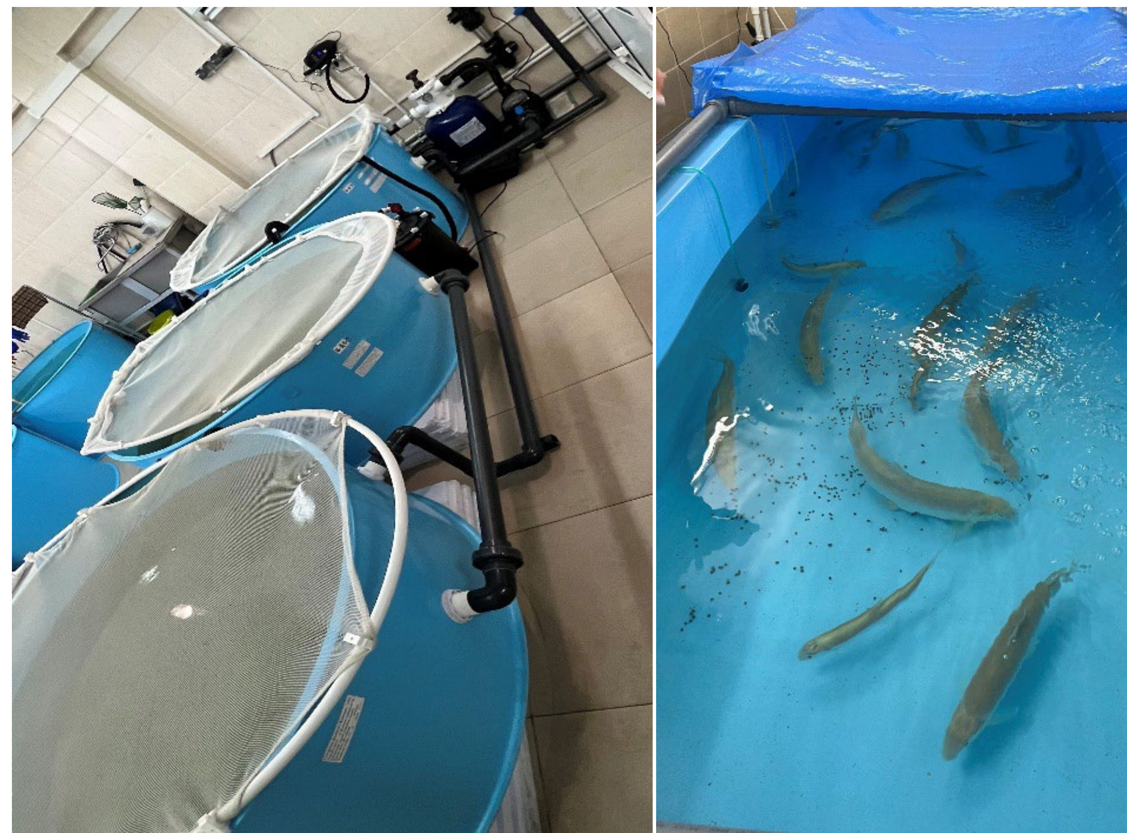
Рис.1. Каскадная установка по выращиванию аквакультур на базе УНУ ПАК
